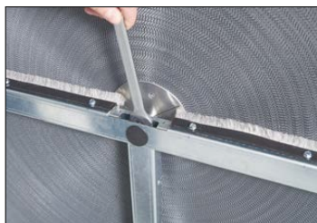
(7) Lösen Sie die Sechskantschraube
