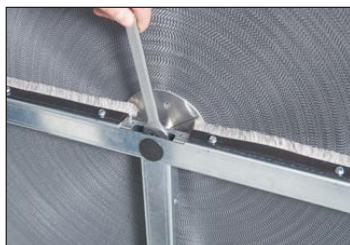
(7) Lösen Sie die Sechskantschraube
