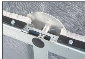
(5) entfernen Sie die Lagerabdeckung mit der Bürstendichtung
