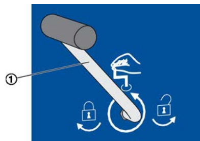
Abb. 61: Funktionsprüfung (ohne angeschlossene Versorgungsspannung)
