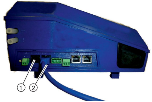
Abb. 5: Anschluss Regler TCU3 oder Adaptermodul TAM
