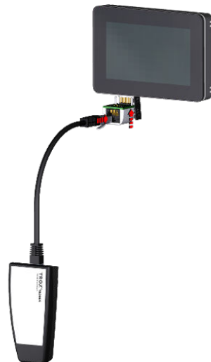
Abb. 8: Verbindungsaufbau mit Konfigurationsadapter und Bluetooth-Adapter BlueCON
