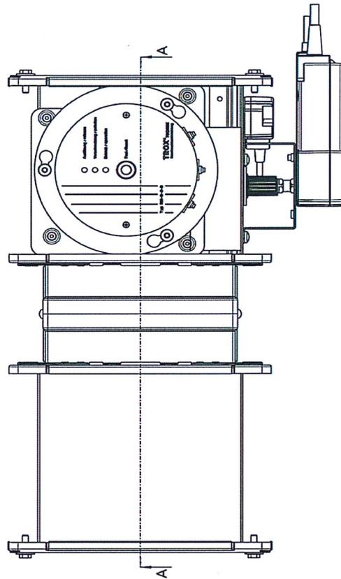
Feuerwiderstandsfähiger Abschluss Typ "FK2" besonderer Bauart und Anwendung
